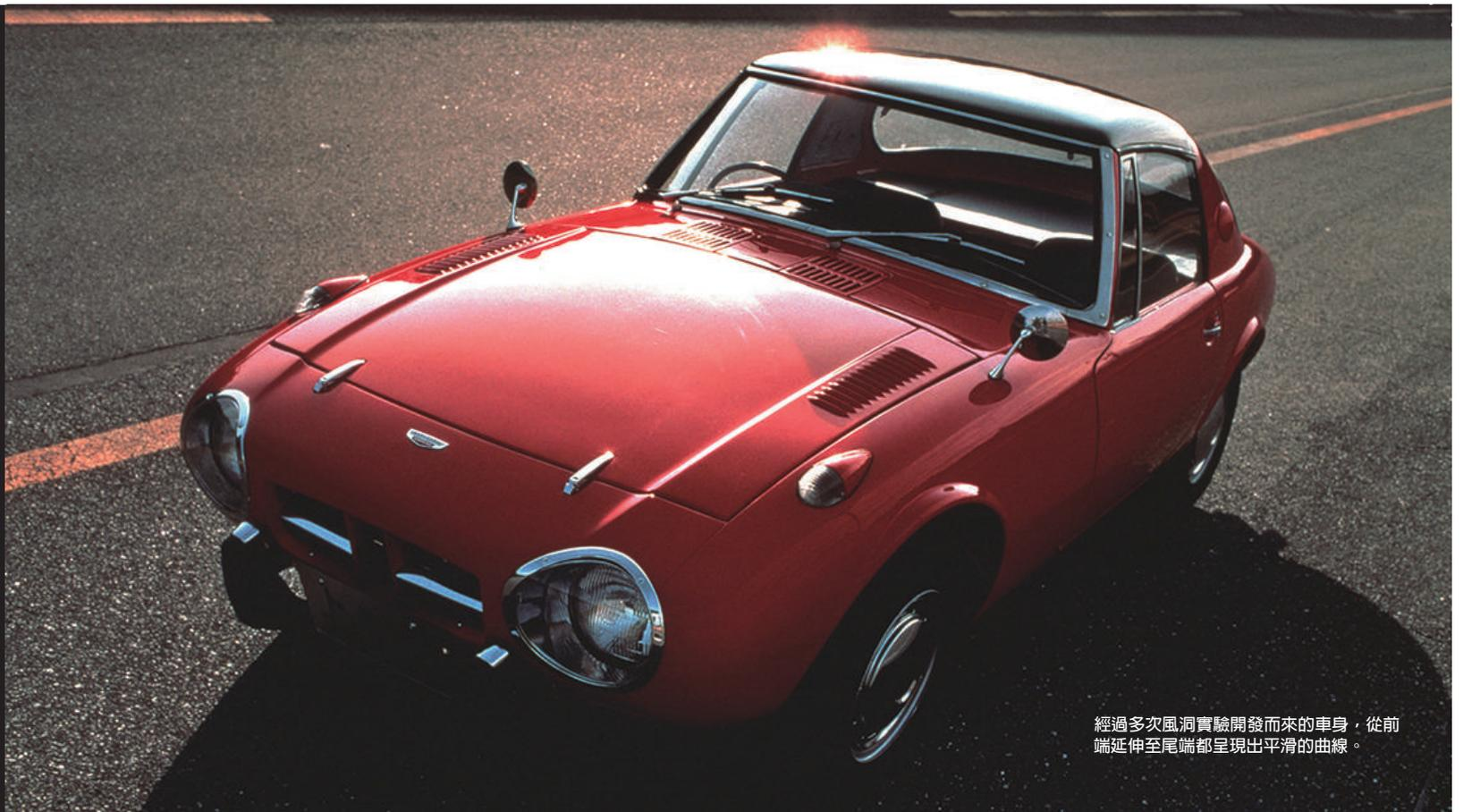
經過多次風洞實驗開發而來的車身，從前端延伸至尾端都呈現出平滑的曲線。
