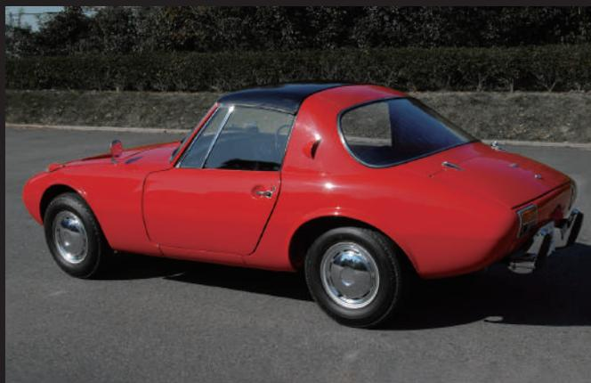
車頂面板由6根螺柱固定。拆卸後可輕鬆體驗開放式行駛的樂趣。
