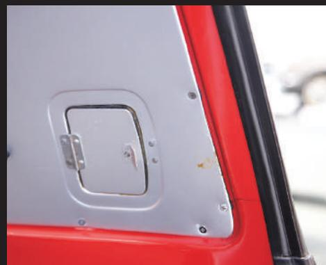
安裝在車柱部分的通風口。打開蓋子可以使車內通風。
