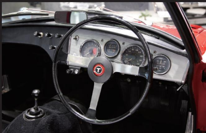
與引擎蓋呈現相同曲線的儀錶板。在後來的型號中,儀錶周圍的鋁製面板已改為黑色。
