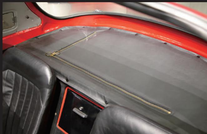
打開座椅後方的拉鍊,可以收納車頂。車頂、引擎蓋和行李箱蓋都是輕量的鋁製。
